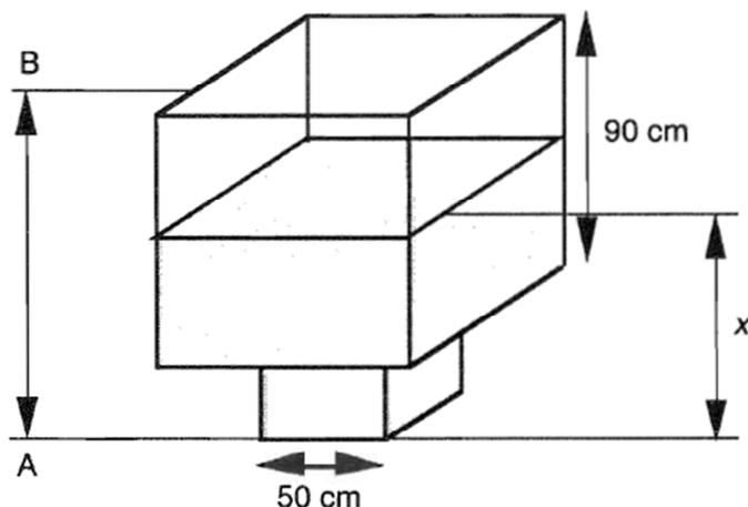
Une cuve est formée de deux cubes superposés qui communiquent entre eux. L'arête du cube supérieur (le grand cube) mesure 90cm. L'arête du cube inférieur (le petit cube) mesure 50cm. Cette cuve contient un liquide. On note  $x$  la hauteur de liquide dans la cuve. On note  $V(x)$  le volume en litres du liquide dans la cuve lorsque la hauteur est  $x$  ( $x$  étant exprimé en cm).
