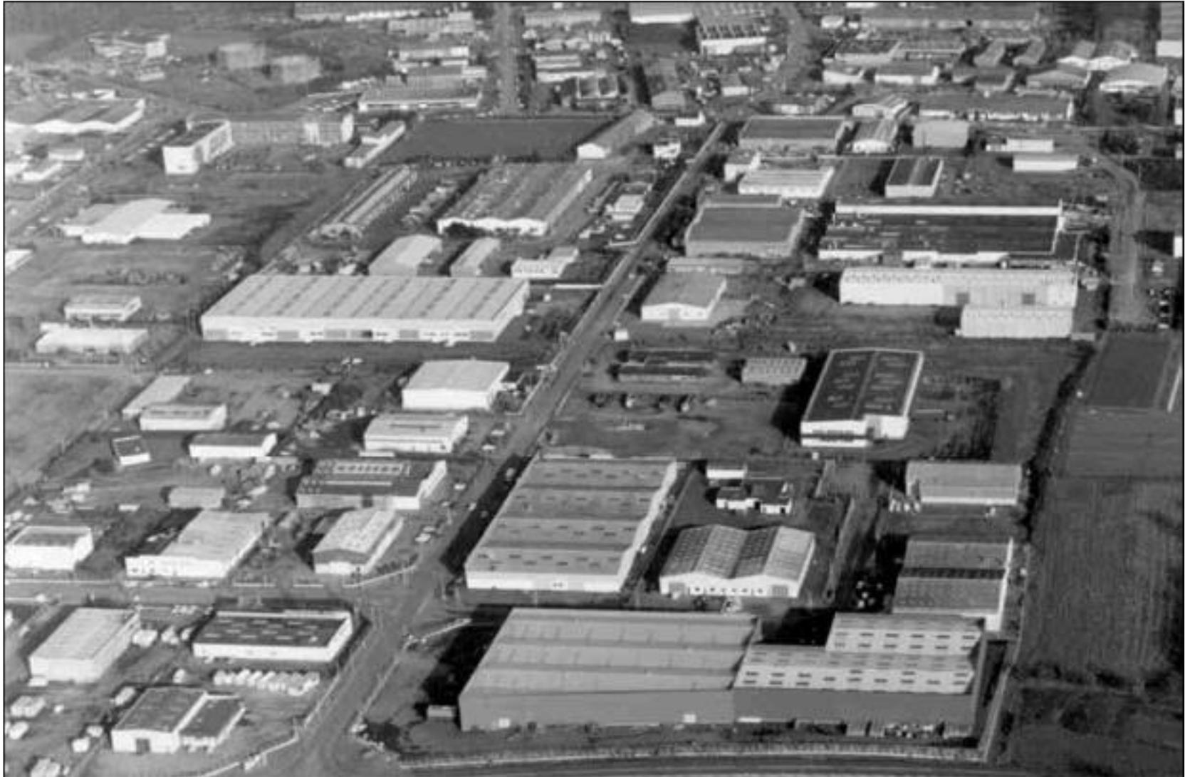
**Figure 4.11(NA) — Rugosité IIIb (zone industrielle)**
