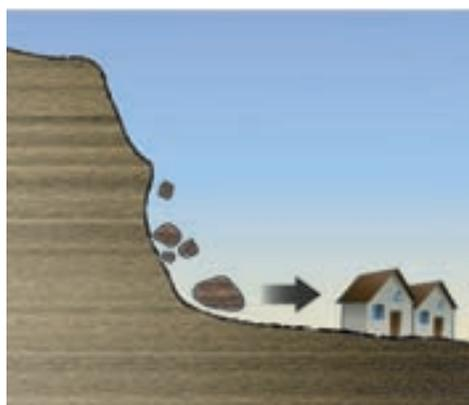
**Fig. 9 - Sur les versants, les glissements de terrain et les éboulements rocheux déclenchés par un tremblement de terre sont assez fréquents. Ils peuvent entraîner la perte totale des ouvrages qui y sont implantés. Même un séisme de faible intensité peut provoquer un glissement de terrain ou un éboulement**
