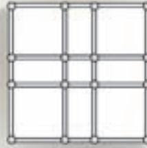
Lorsque l'irrégularité des trames est due à la forme du bâtiment, celui-ci peut être exposé à une torsion d'ensemble. Pour l'éviter, on peut placer des éléments rigides (voiles) dans la zone flexible de l'ossature afin d'obtenir une symétrie de la rigidité à chaque niveau (fig. 71). La torsion est commentée au paragraphe 6.3.2.
