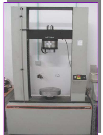
La mesure de la résistance mécanique des carottes va permettre de voir si le béton a perdu ses capacités initiales de résistance.
