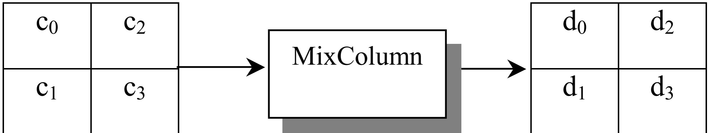
$$\begin{bmatrix} d_0 \\ d_1 \end{bmatrix} = \begin{bmatrix} 3 & 2 \\ 2 & 3 \end{bmatrix} \begin{bmatrix} c_0 \\ c_1 \end{bmatrix}$$
