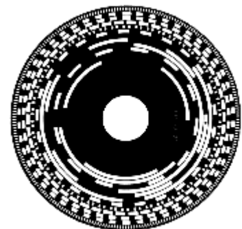
Disque de codeur absolu 12 pistes soit 4096 positions
