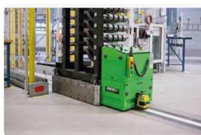
Turck Banner La RFID guide l'AGV dans la production de suspens...
