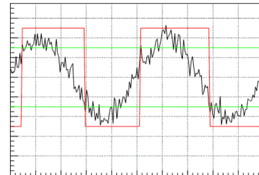
Figure 50 : Formes d'ondes Trigger de Schmitt non inverseur
