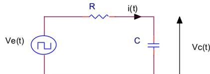
Avec :  $R = 22 \text{ k}\Omega$  et  $C = 47 \text{ nF}$ .
