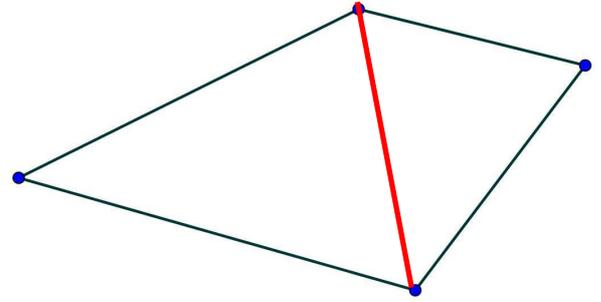
Une « clef » : tracer une diagonale. Du coup, le quadrilatère est le « collage » de deux triangles ayant un côté commun (*la diagonale*). Donc, construction facile : on construit un premier triangle par report au compas de ses trois côtés et on construit le deuxième triangle « collé » par report successifs des deux autres côtés restants. Élémentaire, au sens de Watson !
