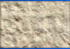
Aspect martelé gros avec une boucharde à 16 points
