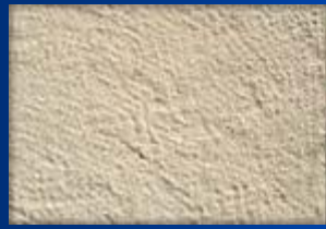
Aspect martelé fin avec une boucharde à 36 points
