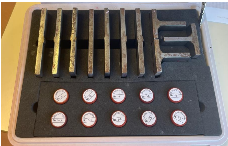
Figure 4 : Les différentes soudures sur les plaques en acier à étudier
