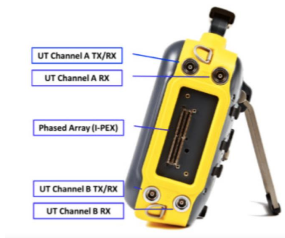
Figure 2 Nous avons à disposition deux sondes émettrices/réceptrices d'ultrasons :
