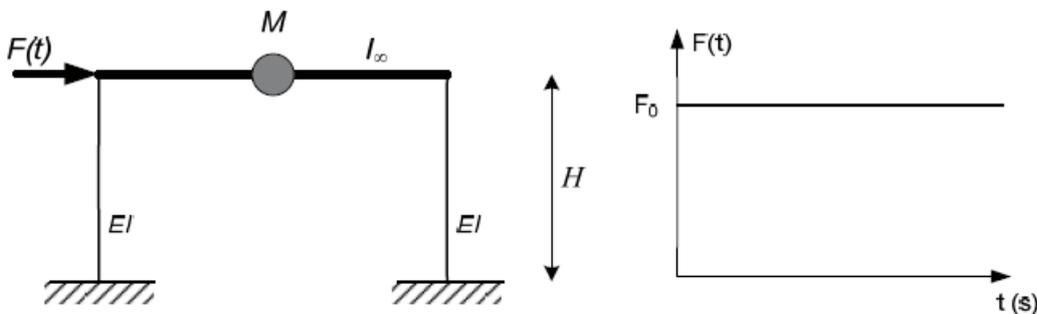
**Exercice 5 :** Une fondation antivibratoire est installée dans un hall dont les perturbations ambiantes induisent des vibrations fréquence de 24 Hz et de 0.25 mm. Nous voulons l'amplitude des vibrations du bloc isolé, d'une masse M=1tonne, ne dépasse pas 0.05 mm.
